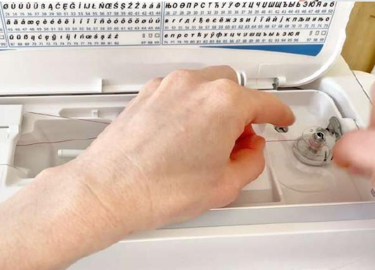
Spingere la spolina verso destra. Avviare la macchina da cucire e controllare il corretto avvolgimento del filo. Arrestare la macchina al termine del caricamento del filo.
