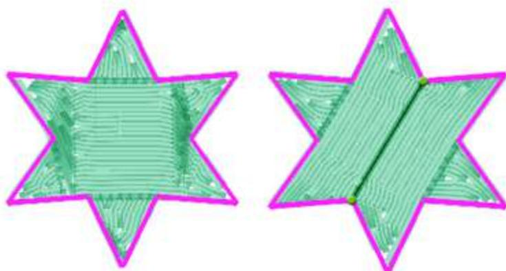
Ora puoi continuare ad aggiungere linee di divisione o passare a qualsiasi altro strumento. Allo stesso modo, se si avvia lo strumento Direzioni, è possibile aggiungere una o più linee di direzione prima di passare a un altro strumento.
