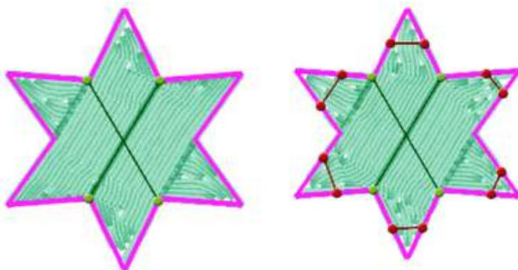
La terza opzione dello strumento Flusso dei punti è "Punti direzionali" e appare solo sui tipi di punto "Riempi zigzag" e "Riempi riga di colore". Usando questa modalità, puoi specificare un punto su un oggetto e quell'oggetto sarà riempito con linee di colore a partire dal suo bordo esterno verso il punto selezionato.
