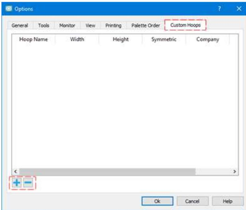
Per creare un telaio personalizzato devi impostare le dimensioni che desideri avere, seleziona il produttore della macchina e il modello della macchina, seleziona la forma del telaio e definisci un nome, quindi aggiungilo all'elenco dei telai premendo il **Aggiungi** bottone
